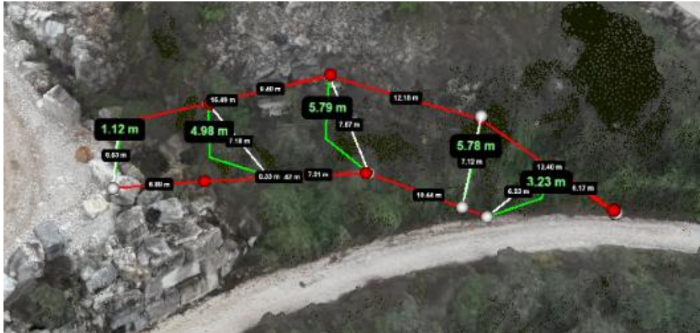
Figura 1 – Vista tridimensionale dello stato attuale e del tracciato previsto del nuovo tratto di strada
